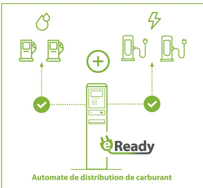
En simplifiant, on peut dire qu'avec eReady, l'électricité devient une sorte de carburant supplémentaire que vous pouvez désormais proposer à votre station-service. Par l'intermédiaire du protocole Open Charge Point, le processus d'autorisation se déroule de manière fiable, y compris aux bornes de recharge.
